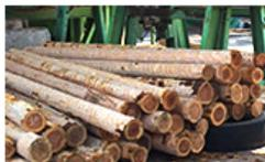
リングパーカーによる皮剥作業。剥がした皮はボイラーの燃料に利用。
